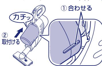
本体の溝とダストケースの突起部を合わせて、本体にダストケース全体を押し付けるように「カチッ」と音がするまで確実に取付けてください。
