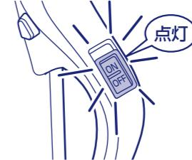
充電中はスイッチ部にある充電表示ランプが点灯しつづけます。充電完了後自動的に消灯します。(充電時間:約5時間)
