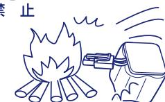
電解液が吹き出したりして破裂の原因になります。
