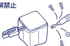
液漏れ・発熱・破裂の原因になります。
