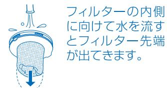
フィルターの内側に向けて水を流すとフィルター先端が出てきます。
