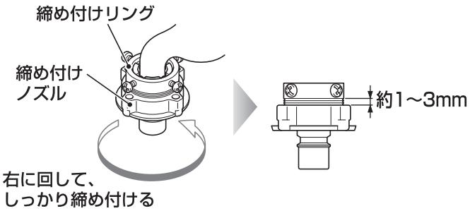
!締め付けることによって給水ホースジョイント内のゴムパッキンと水栓の先端が密着し、水漏れを防止します。
