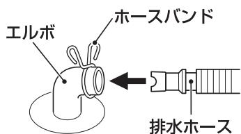
●排水ホースの先端部をエルボにしっかりと差し込み、ホースバンドで確実に固定してください。
