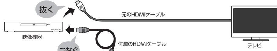
● 映像機器とテレビの間にスピーカーなどを接続している場合は、必ず映像機器とスピーカーの間に送信機を接続してください。
