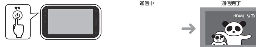
防水モニターの電源を入れると、送信機と通信を開始します。防水モニターには通信中画面が表示されたあと、映像が映ります。
