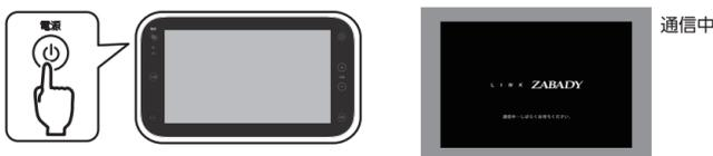
防水モニターの電源を入れると、送信機と通信を開始します。防水モニターには「通信中」という画面が表示されます。電源ボタンを押したあと、通信を開始するまでにしばらく時間がかかることがあります。
