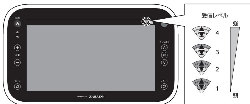
受信レベルは、防水モニターが受信している電波の強さを表しています。チューナーとの通信状態の目安になりますが、他の機器からの電波干渉の影響によっては、受信レベルが高くても映像が途切れたり止まったりすることがあります。
