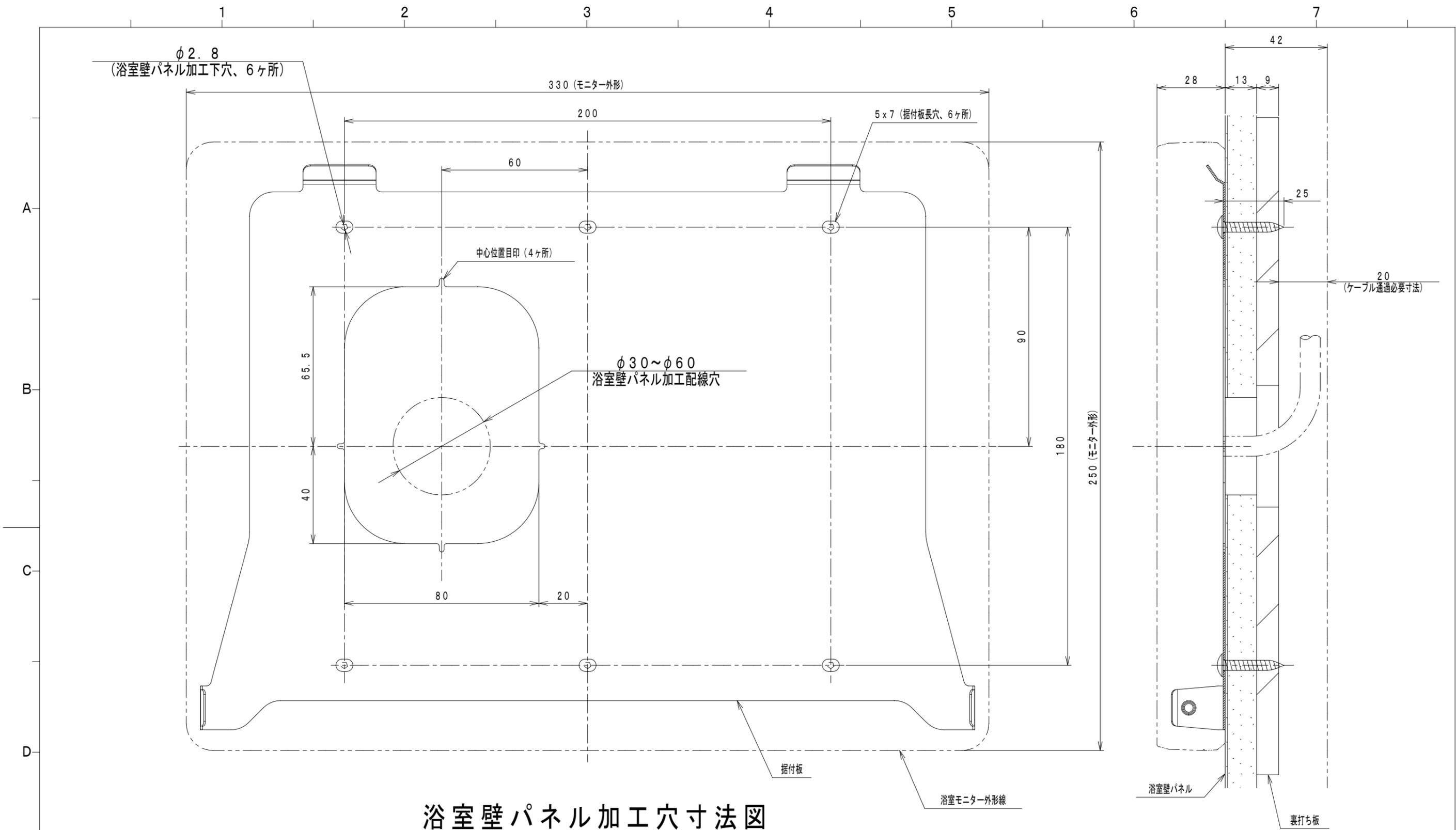
浴室壁パネル加工穴寸法図
