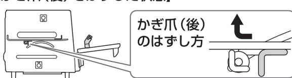
③ かぎ爪(前)をはずした状態でワイヤーラックを奥まで戻したのち、持ち上げて横軸からかぎ爪(後)をはずします。
