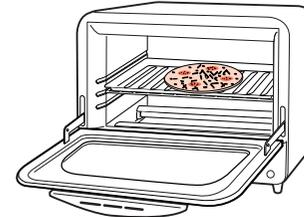
油が飛び散りやすい物や焦げやすい物、焦げすぎの場合には、アルミホイルを敷いたり、かぶせたりしてください。タイマーつまみを回して、調理時間を設定します。調理時間を10分以下に設定するときは、タイマーつまみを一度1份以上に回してから戻して合わせてください。使用中にヒーターが消えることがあります。故障ではありません。温度調節のためについたり消えたりします。
