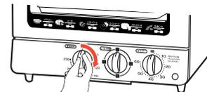
温度調節つまみをまわして、調理温度を設定します。ヒーター切替つまみをまわしてヒーターを切り替えます。タイマーつまみをまわして予熱時間を設定すると、加熱を開始します。(通電ランプが点灯します。)予熱時間は目安を参考にしてください。
