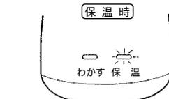
コードを接続すると、わかすランプが点灯し、湯わかしを始めます。湯わかしが終わると、自動的に保温に切りかわり保温ランプが点灯します。保温を続けるときは、電源プラグを抜かないでください。電源プラグを抜きますと、徐々に湯温がさがります。
