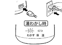
マグネットプラグを本体に接続し、電源プラグをコンセントに差し込みます。ランプが点灯して湯わかしを始めます。
