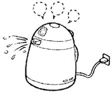
電源プラグやマグネットプラグの抜き差しは、湯わかし中にはしないでください。湯わかし中に抜き差しすると、スパークしてプラグをいためることがあります。
