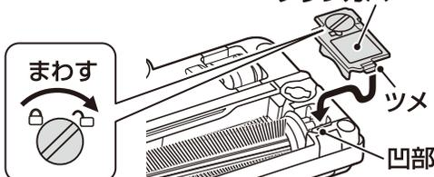
④ ブラシカバーの溝にコインなどを入れ矢印の方向に下図の位置まで回してブラシカバーを取付けます。
