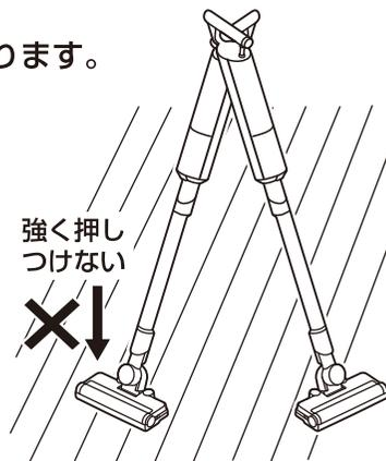
吸気路がふさがっている状態(延長管、パワーブラシにゴミが詰まっている状態)で運転を続けると、保護装置がはたらき、表示ランプが紫色で速く点滅(0.5秒に1回)し、運転が停止して操作できなくなります。
