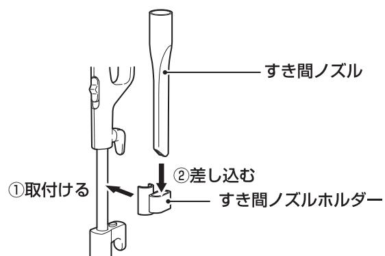
すき間ノズルホルダーをパイプに取付け、すき間ノズルを差し込みます。
