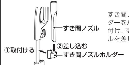
すき間ノズルホルダーをパイプに取り付け、すき間ノズルを差し込みます。
