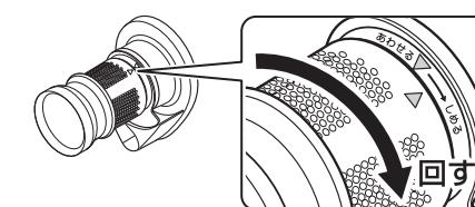
アウターフィルターの「▲」印を「しめる」の方向へまわします。
