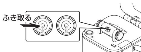
吹出口の内側にも水滴が付着している場合があります。そのまま使用すると、湯滴が飛び原因になりますので、吹出口内側もふき取ってください。
