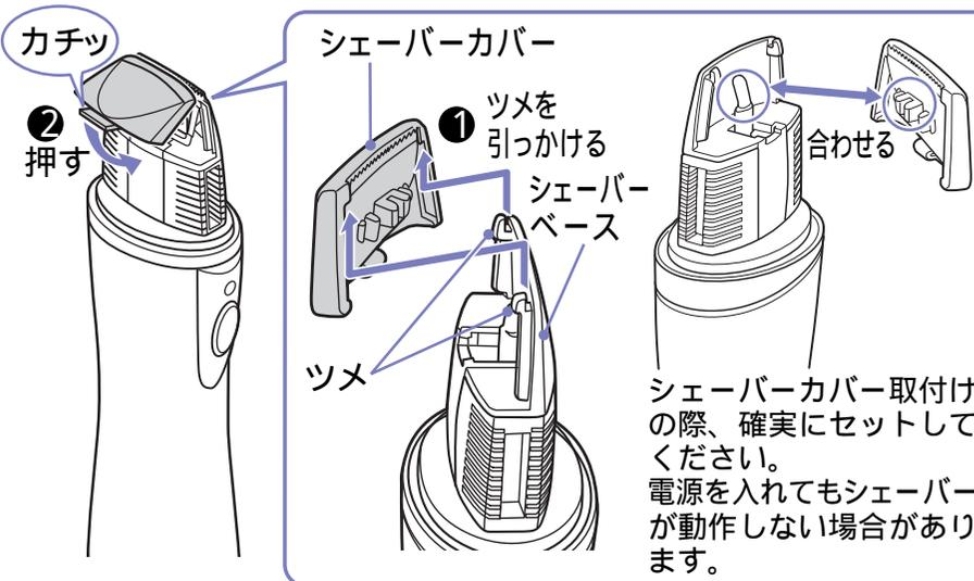
シェーバーカバー取付けの際、確実にセットしてください。電源を入れてもシェーバーが動作しない場合があります。
