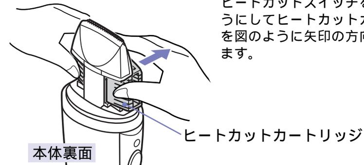
ヒートカットスイッチを押さないようにしてヒートカットカートリッジを図のように矢印の方向に押し出します。
