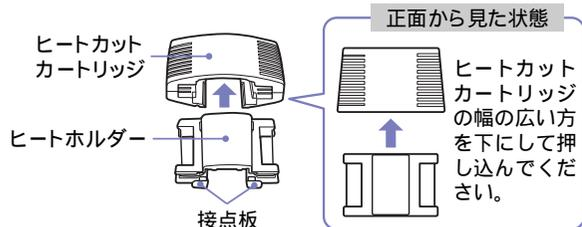
シェーバーベースの柱にヒートカットカートリッジを合わせて、矢印の方向に押し込みます。
