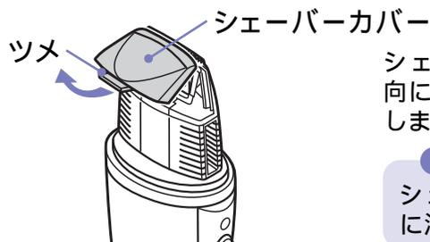
シェーバーカバーのツメ部を刃の方向に倒しながら矢印の方向に取りはずします。
