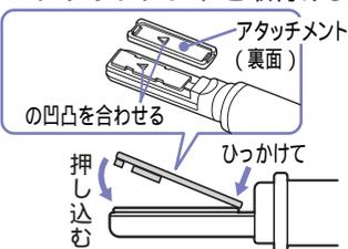
アタッチメントの取付け方向を合わせます。アタッチメントの片方のフックを取付け台にひっかけて、押さえながら反対側を押し込みます。(「カチッ」と音がするまで確実にはめ込んでください。)
