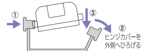
ヒンジカバーを外側へひろげながら取付けます。
