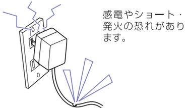
**禁止** コードを傷付けたり、破損したり、加工したり、無理に曲げたり、引っ張ったり、ねじったり、たばねたりしないでください。また、重い物を載せたり、挟み込んだり、加工したりすると、電源コードが破損し、火災・感電の原因になります。
