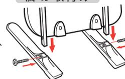
本体の支柱を脚にはめ込みます。ボルトを入れてプラスドライバーで締め付けます。
