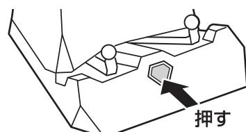
3.電源スイッチを押して、消灯します。
