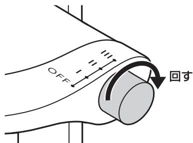
4. 調光ダイヤルを操作して、消灯します。
