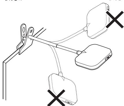
上図のようにフレキシブルシャフトを水平にした状態での左右の可動は保持力低下となりますので、避けてください。
