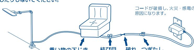
コードが破損し、火災・感電の原因になります。
