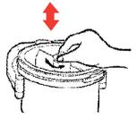
容器にギヤ、回転板、スペーサがセットされ、ツマミでしっかり固定されていることを確認します。本体におくときは、容器のギアと本体のギアが確実にかみ合う様に、回転板を少し回しながらおきます。
