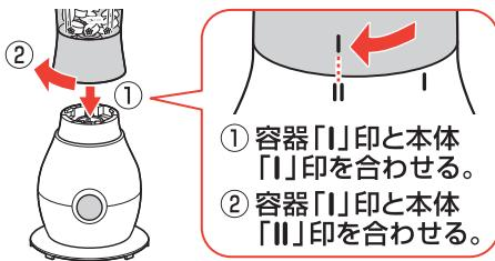
容器を本体に載せ(①)、時計回りに回して(②)取付けます。
