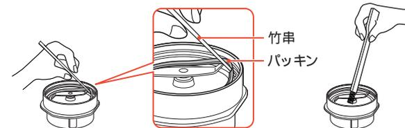
水を入れ約10秒運転しても汚れが落ちない場合は、容器台を取りはずして付属のヘラ付ブラシで落としてください。パッキンは竹串などの先が細く長いものをパッキンの凹部に入れて引っかけてははずします。カッターに手が触れないように、十分ご注意ください。パッキンをキズつけないよう注意してください。
