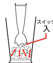
ブレンダーカッターを材料に接した状態で、小刻みに上下させたり容器に沿わせて隅に向けて動かしたりする。
