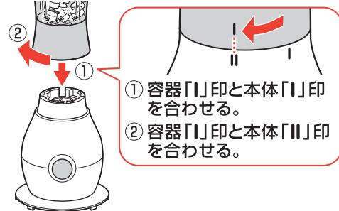
容器を本体に載せ(①)、時計回りに回して(②)取付けます。
