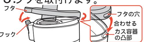
フタの穴にカス容器の凸部を合せます。フタをカス容器に確実に取付けます。フタをフックでロックします。フタを確実に取付けていないと、保護スイッチにより動作しません。
