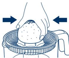
コーンを押ししている間だけ自動的に電源が入り、コーンが回転し、ジュースがしぼれます。コーンは押しつけるタイミングで右にも左にも回転しますが、異常ではありません。しぼる量は最大目盛り(約 400ml)以下でお使いください。
