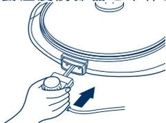
自動温度調節器を「切」にし、差し込み口に根元まで確実に差し込みます。
