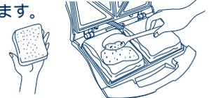
予熱が終わったら、ストッパーをはずし、カバーを開けます。プレート(下)に、バターをぬった面を下にして、パンを置きます。パンの上にお好みの具をのせ、もう一枚のパンを、バターをぬった面を上にして、置いてください。上にのせるパンは5mmほど奥にずらして置くときれいになります。ハンドルを持ってゆっくりとカバーを閉じ、ストッパーをロックします。
