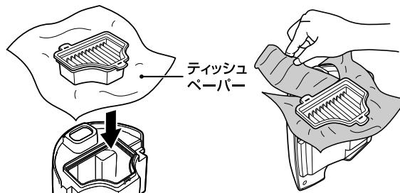
ダストケースに取付けた後、はみ出したティッシュペーパーは必ずフィルターの形状に合わせて切り取ってください。はみ出した部分があると、ダストケースが本体に正しく取付けできません。
