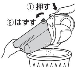
ダストケース着脱ボタンを押して、ダストケースをはずします。
