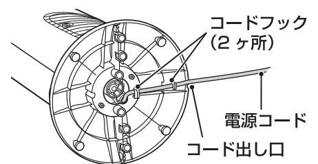
電源コードを後ベースのコードフック(2ヶ所)の下に通し、コード出し口にはめ込みます。
