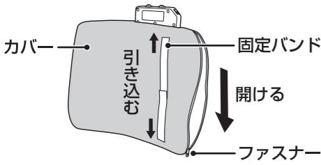
2. コントローラー部のカバーを引っ張り、コントローラーをカバーの内側に入れます。
