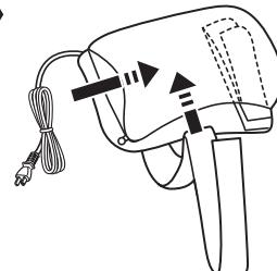
保管時は、本体とマッサージ部カバーとの間に電源コードと持ち手を収納できます。
