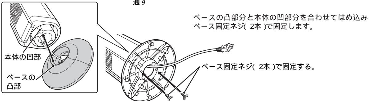
ベースの凸部分と本体の凹部分を合わせてはめ込みベース固定ネジ(2本)で固定します。
