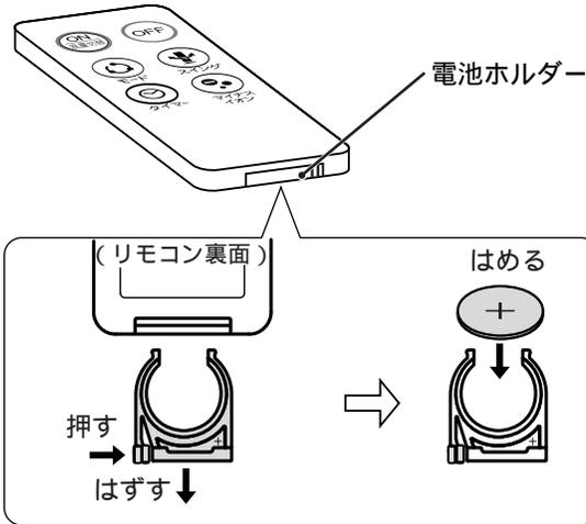
リモコンの電池ホルダーを矢印の方向にはずします。
