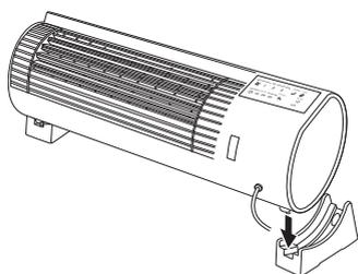
上記1と同じ位置の溝に本体金具の落下防止チェーン取付部を差し込みます。
