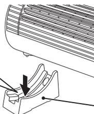
本体金具の落下防止チェーン取付部と据置用スタンドの溝とを合わせて差し込みます。据置用スタンドには、5ヶ所の溝がありますので、お好みの角度に応じて差し込み位置を設定してください。
