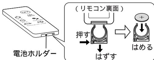
リモコンの電池ホルダーを矢印の方向にはずします。
