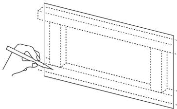
マーキングしたネジ位置に壁掛け金具(2個)を付属のネジ(大×各4本)で確実に固定します。
