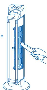
4. 後カバー・後カバー固定ネジを元通りに取付けます。
