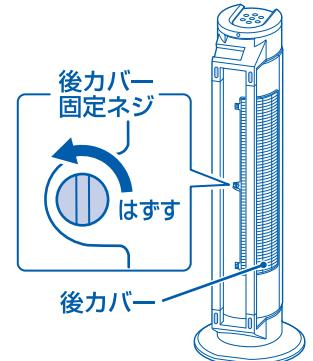
2. 後カバーのツメ(2箇所)を押しながら開いて、矢印の方向に引き抜きます。
