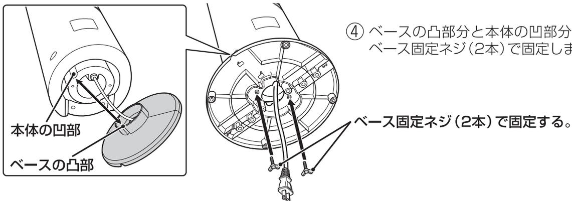
④ ベースの凸部分と本体の凹部分を合わせてはめ込みベース固定ネジ(2本)で固定します。
