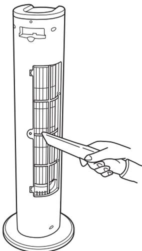
4. 後カバー・後カバー固定ネジを元通りに取付けます。
