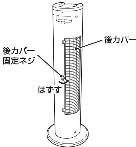
2. 後カバーのツメ(2箇所)を押しながら、後カバーを矢印の方向にはずします。
