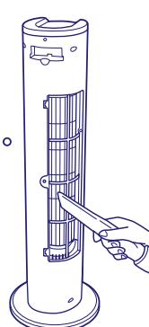
4. 後カバー・後カバー固定ネジを元通りに取付けます。
