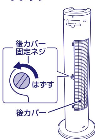
2. 後カバーのツメ(2箇所)を押しながら開いて、矢印の方向に引き抜きます。
