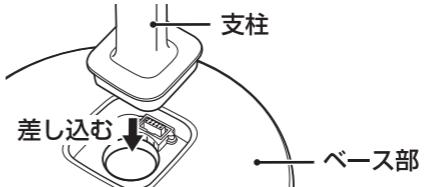
② 支柱とベース部を手で押さえながら横に倒し、ベース固定ナットを右回りにしめつけて固定します。
