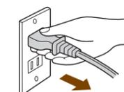
電源プラグをコンセントから抜いてください。製品が熱くなっていますので、十分に冷えてからお手入れをしてくださいます。
