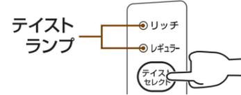
③ テイストセレクトボタンを押すごとにテイストランプが「リッチ」と「レギュラー」に切り替わります。選択したテイストランプが点灯します。
