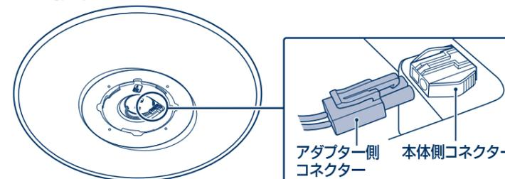
アダプター側コネクターを本体側コネクターに確実に差し込んでください。アダプター側コネクターを引っ張り、抜けないことを確認してください。
