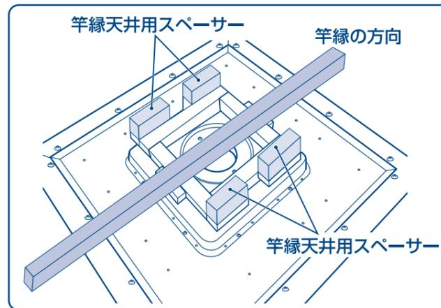
！ 竿縁天井用スペーサーが、竿縁の方向に対して上図の位置になるように取付けます。
