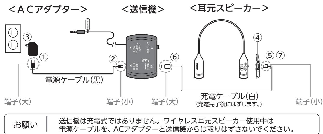
1 付属の黒色の電源ケーブルの端子(大)を、ACアダプターのソケットに差し込む。
