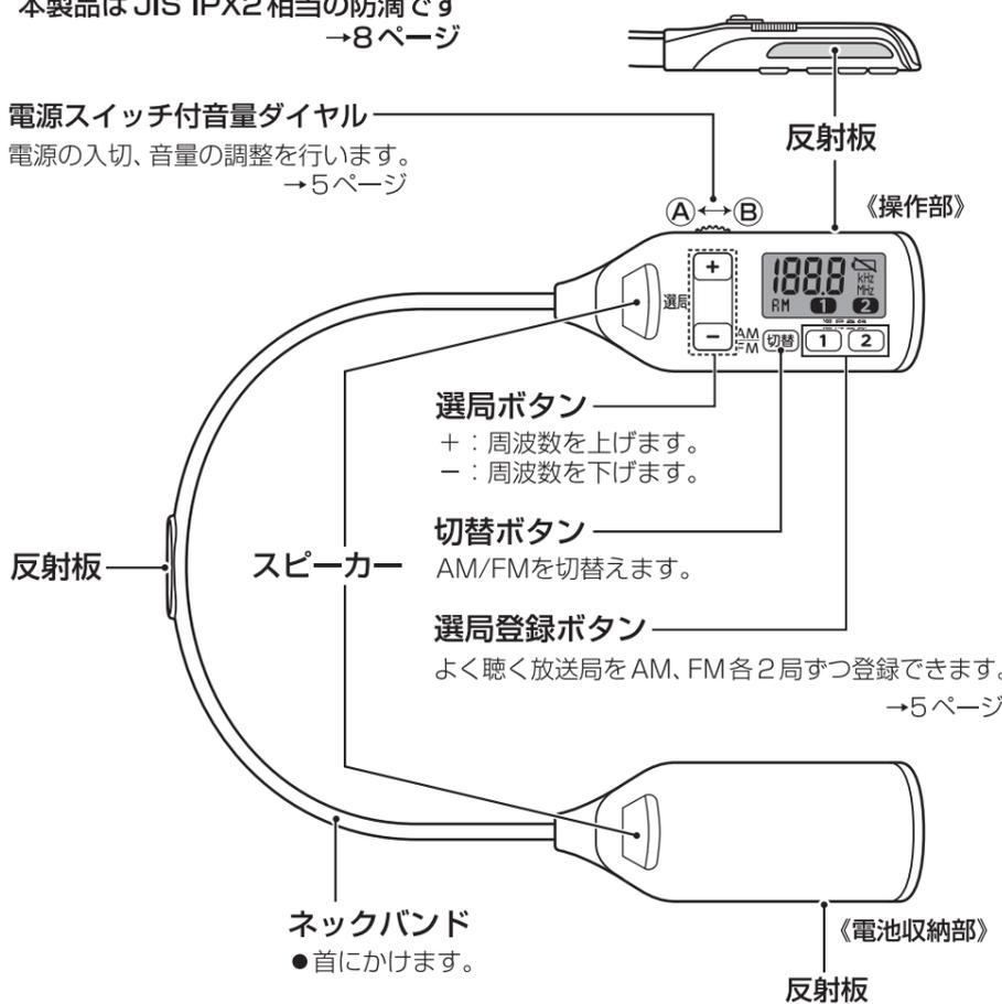
表示画面 ●ボタン操作時に約 10 秒間バックライトが点灯します。
