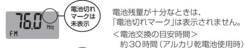
電池残量が十分なときは、「電池切れマーク」は表示されません。<電池交換の目安時間> 約30時間(アルカリ乾電池使用時)
