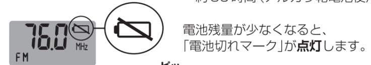
電池残量が少なくなると、「電池切れマーク」が点灯します。
