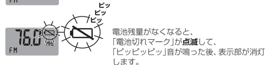
電池残量がなくなると、「電池切れマーク」が点滅して、「ピッピッピッ」音が鳴った後、表示部が消灯します。
