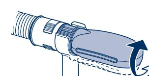
吹き飛んだ水滴がシンク内に入るよう吹出しノズルの角度をシンク内に向けます。
