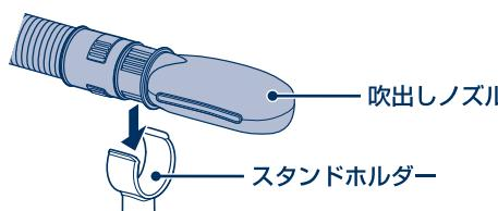
② 吹出しノズルの角度を調整します。
