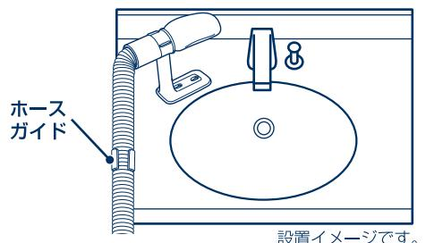
④ ホースガイドの吸盤の突起部を押して、密着させます。
