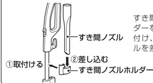
すき間ノズルホルダーをパイプに取り付け、すき間ノズルを差し込みます。
